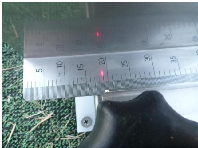
角度測定事例（0.5度単位まで正確に調整可能）
